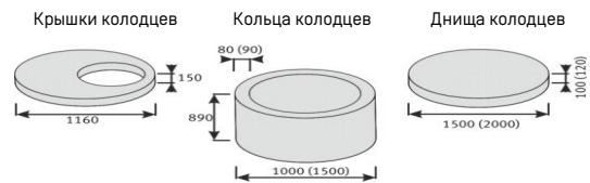
Предназначены для перекрытия смотровых колодцев, водопроводных и канализационных сетей.
