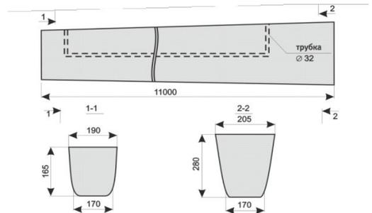
Железобетонные стойки СВ-110-3.5 (Серия 3.407.1-143)
