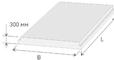
Предназначены для устройства перекрытий и покрытий жилых и общественных зданий высотой до пяти этажей. Плиты рассчитаны на расчетную нагрузку 600 кг/м<sup>2</sup>.
