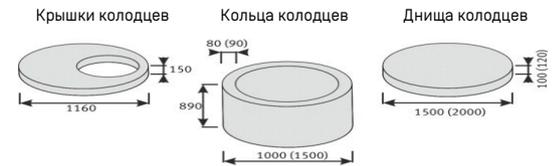
Предназначены для перекрытия смотровых колодцев, водопроводных и канализационных сетей. Класс бетона по прочности на сжатие В15. Марка бетона на морозостойкости F50
