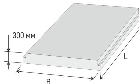
Предназначены для устройства перекрытий и покрытий жилых и общественных зданий высотой до пяти этажей. Плиты рассчитаны на расчетную нагрузку 600кг/м2
