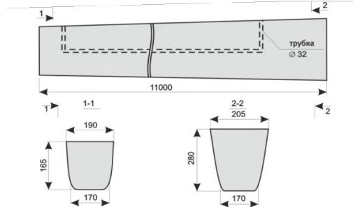
Железобетонные стойки СВ-110-3.5 (Серия 3.407.1-143) предназначены для высоковольтных линий электропередачи до 10 кВ и устройства опор освещения.
