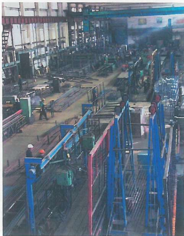
Подвесная установка сварки каркасов
